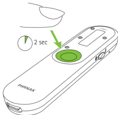
La mise en sourdine du microphone est indiquée sur l'écran par une icône de microphone barré. Pour désactiver la mise en sourdine, appuyez et maintenez enfoncé le bouton de la fonction pendant deux secondes.
