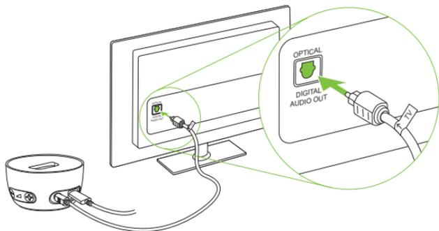
❗ Protégez vos yeux de la lumière optique du câble optique Toslink lorsque ce dernier est branché à l'appareil ou au téléviseur.
