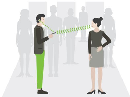
Le microphone active automatiquement un faisceau restreint et reçoit la voix de la personne vers laquelle il est dirigé. Cette fonction est indiquée par un triangle sur l'écran.
