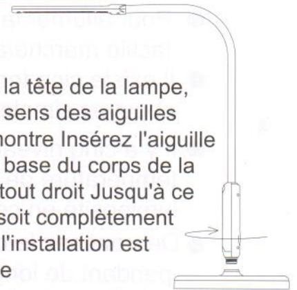
Utilisez la tête de la lampe, dans le sens des aiguilles d'une montre. Insérez l'aiguille dans la base du corps de la lampe, tout droit. Jusqu'à ce qu'elle soit complètement serrée, l'installation est terminée.
