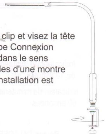
Retirez le clip et vissez la tête de la lampe. Connexion partielle, dans le sens des aiguilles d'une montre. Serrez, l'installation est terminée.
