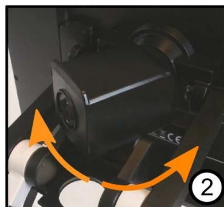
La caméra fonctionne dans deux modes. Le mode lecture et le mode à distance. Tournez la caméra pour passer du mode lecture (1) au mode à distance (2). Une fois que la caméra est en mode à distance, elle peut être inclinée latéralement, en fonction de ce que vous souhaitez
