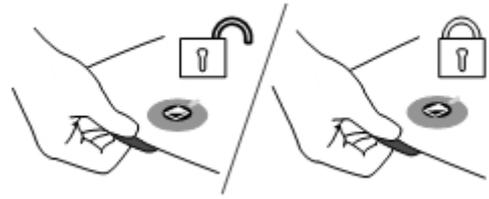
**Nota:** Quando l'apparecchio è spento, o staccato dall'alimentazione elettrica, il freno si attiva automaticamente (posizione di blocco). Quando si accende ClearView<sup>+</sup>, il freno viene disattivato (posizione di sblocco). Assicurarsi di sistemare il piano di lettura XY nella posizione corretta, prima di spegnere l'apparecchio.
