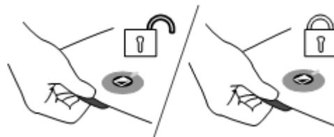
**Remarque:** lorsque le système est éteint, le verrouillage est automatiquement activé (en position verrouillage). Lorsque vous allumez votre système ClearView<sup>+</sup>, le verrouillage est annulé (en position déverrouillage). Assurez-vous que le plateau de lecture est bien centré avant d'éteindre le système.
