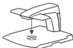
Premendo questo pulsante per tre secondi si attiva un indicatore a LED al centro del piano di lettura. Se si posiziona ad esempio una penna sull'indicatore luminoso del piano di lettura, si vedrà la penna stessa visualizzata al centro dello schermo. Premete di nuovo il pulsante per disattivare l'indicatore a LED.
