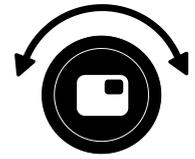
Si los marcadores de líneas o ventanas están activados (ver más abajo) y se quiere cambiar su posición en la pantalla, se hace girar la perilla cuyo ícon aquí se representa. Los marcadores de línea y las ventanas se pueden visualizar en posición horizontal o vertical, según el sentido del botón 🕒
