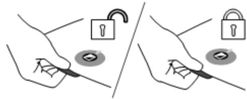
**Achtung:** Wenn der ClearView<sup>+</sup> ausgeschaltet ist, ist der Tisch automatisch festgestellt (Verriegelungsstellung). Sobald Sie den ClearView<sup>+</sup> einschalten, wird der Tisch automatisch wieder beweglich. Schieben Sie deshalb den Tisch in die Ausgangsposition, bevor Sie das Gerät ausschalten.
