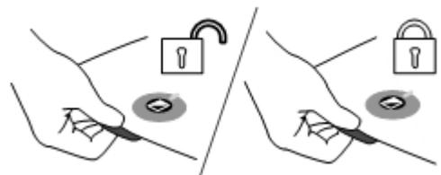
roja situada en la parte delantera del mismo. El freno permite al usuario mantener el tablero detenido firmemente en la posición deseada. El tablero de lectura también puede usarse para escribir a mano o para pintar. Para desbloquearlo, se vuelve a mover la palanca roja hacia arriba.
