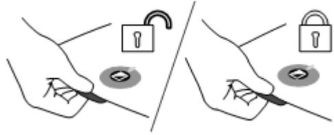
blokkeren. In de geblokkeerde stand worden taken als schrijven en schilderen onder de camera vereenvoudigd. Duw de rode greep nogmaals omhoog om de blokkering op te heffen.
