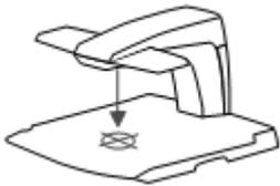
Presionar este botón durante tres segundos activará la luz LED, que aparecerá en el centro del tablero de lectura para marcar el centro de la imagen en pantalla. Ubique un bolígrafo en la luz indicadora del tablero de lectura para verlo aparecer en el centro de la pantalla. Vuelva a oprimir el botón para desactivar la luz LED.
